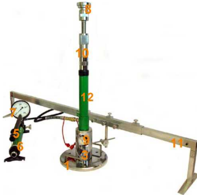
Rys. 1.2 Aparatura VSS z jednopunktowym pomiarem przemieszczenia płyty
